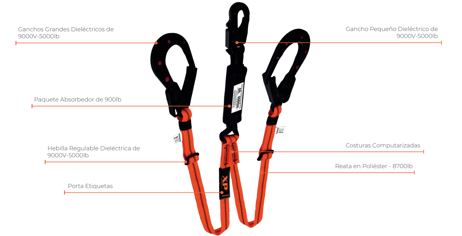
ESLINGA DOBLE REGULABLE DIELÉCTRICA 9kV, CON PAQUETE ABSORBEDOR, EN REATA PLANA POLIÉSTER DE 1".
